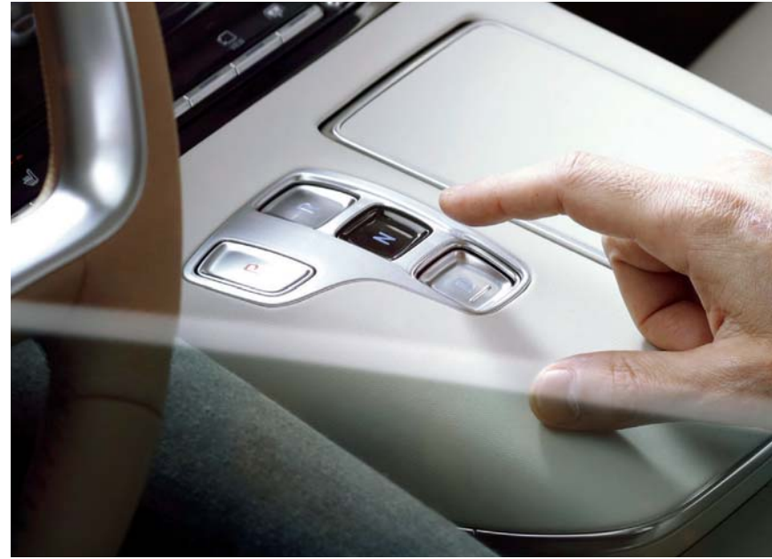
ناقل حركة أوتوماتيكي مزود بتقنية التحكم بنقل الحركة "شيفت باي واير"
