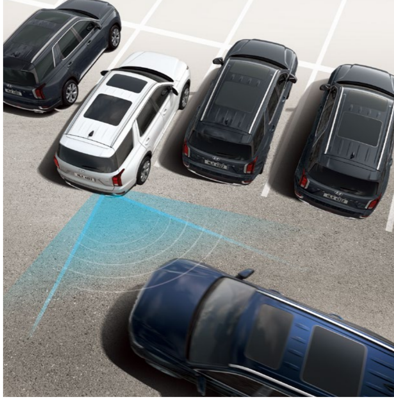
نظام التحذير من الاصطدام الخلفي للسيارات العابرة (RCCW) ومساعد تجنب الاصطدام الخلفي للسيارات العابرة (RCCA)
